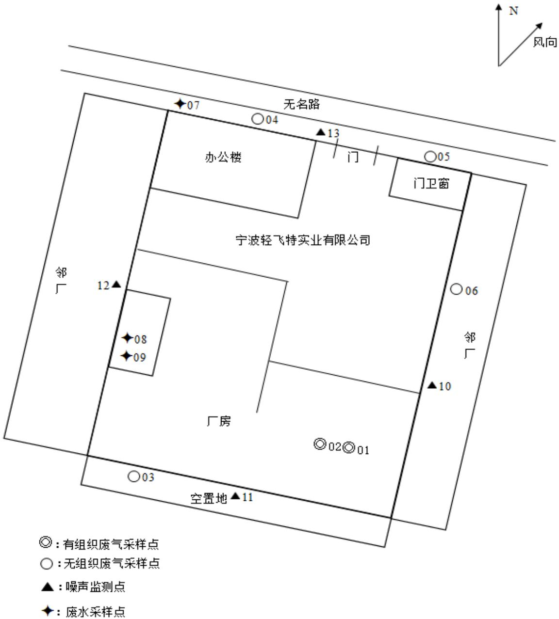
图 3-3 无组织废气及噪声监测点位分布图
