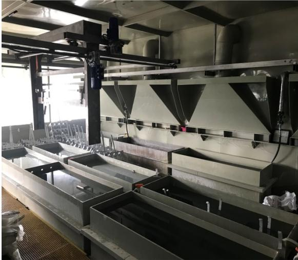
图 2-4 电抛、化学除油、清洗槽
